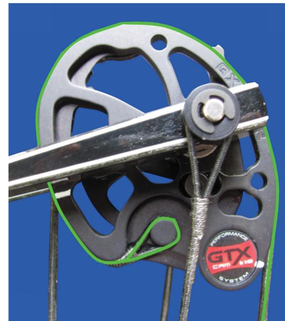
Il cavo di controllo nei suoi alloggiamenti su cam superiore (sx) ed inferiore (dx)
