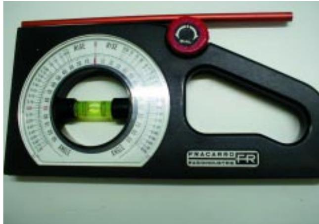
Inclinometro: strumento usato per misurare gli angoli di pendenza
