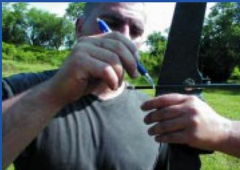
Misurare la potenza dell'arco tenendo il dinamometro sotto cocca.
